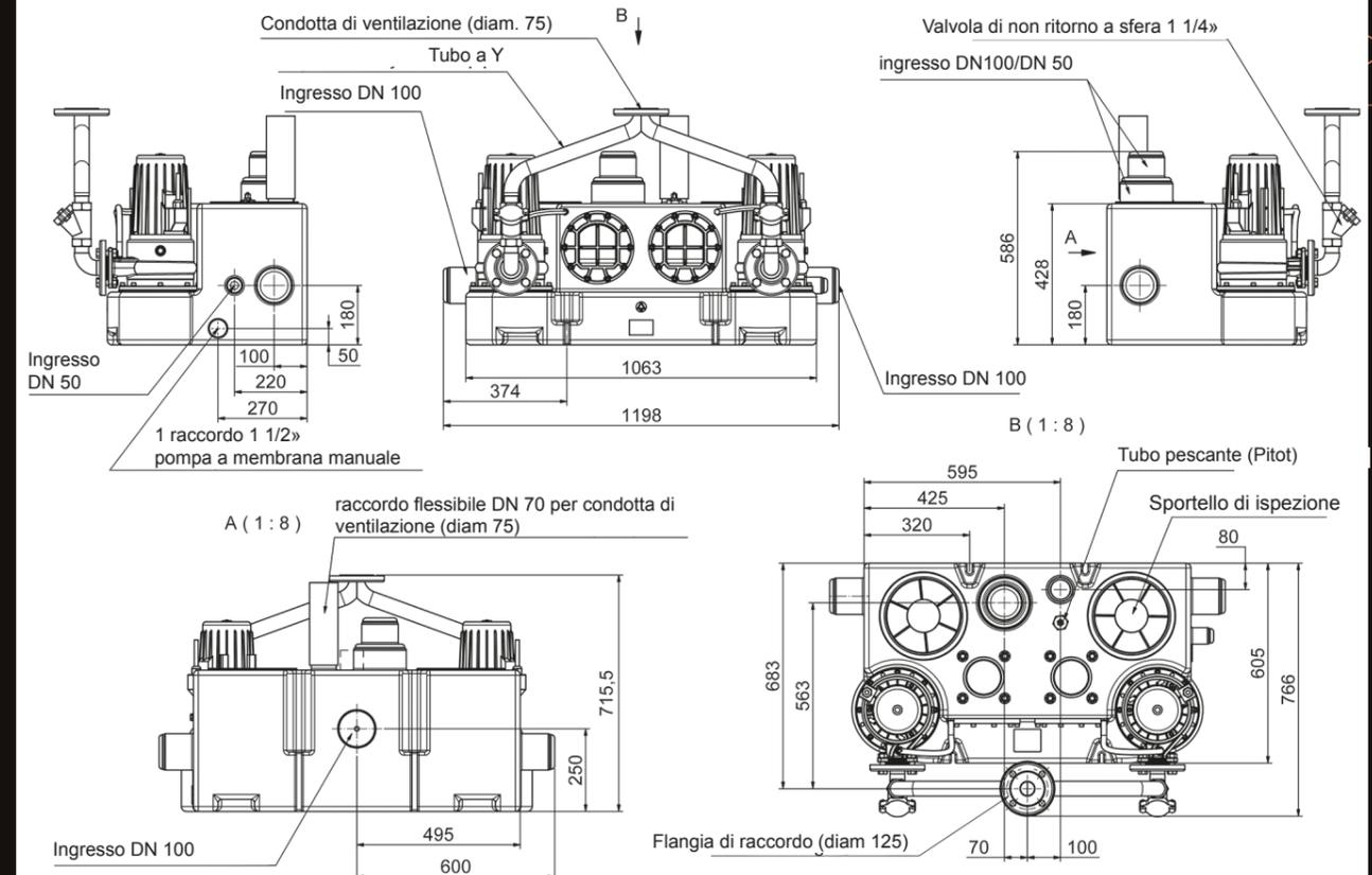
La canalizzazione di ingresso deve essere collocata a un minimo di 250 mm sotto il livello del suolo.
